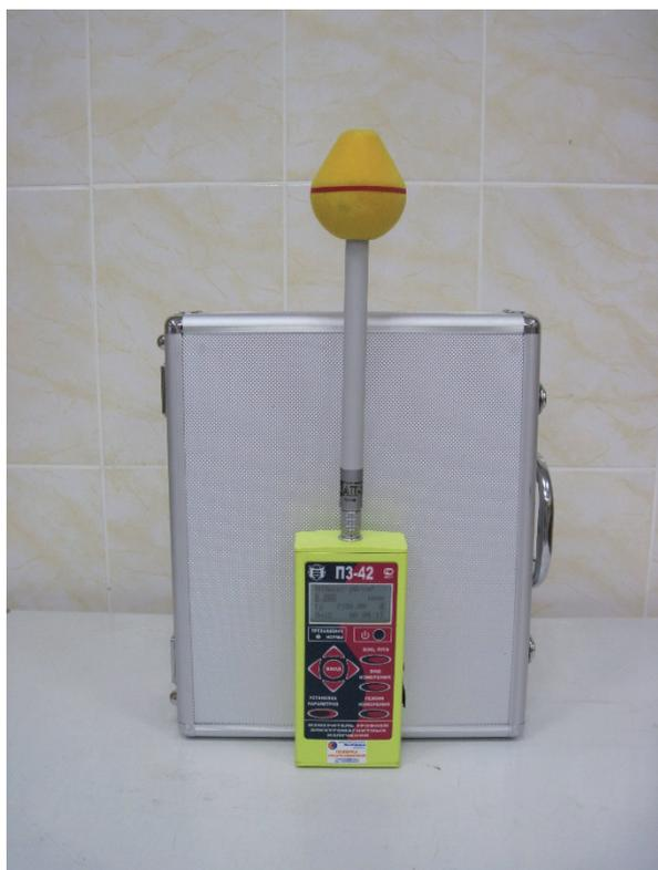
Рисунок 2 – Измеритель электромагнитного поля «ПЗ-42» с антенной-преобразователем СВЧ-диапазона «АП-2».
