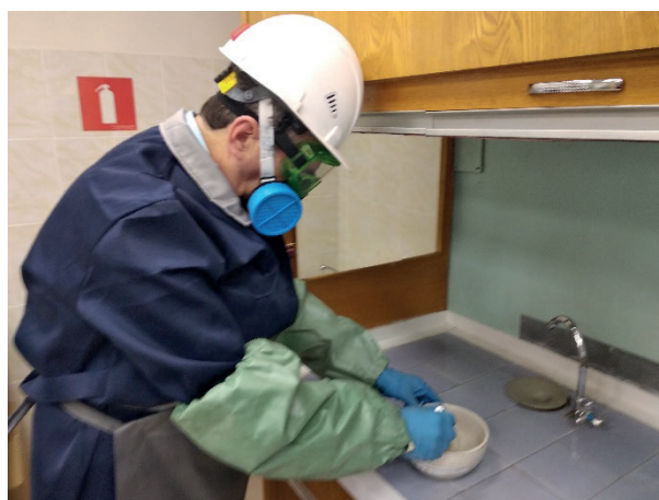
Рисунок 2 – Применение средств индивидуальной защиты при утилизации индикаторных трубок в аккредитованной лаборатории гигиенического мониторинга условий труда.
